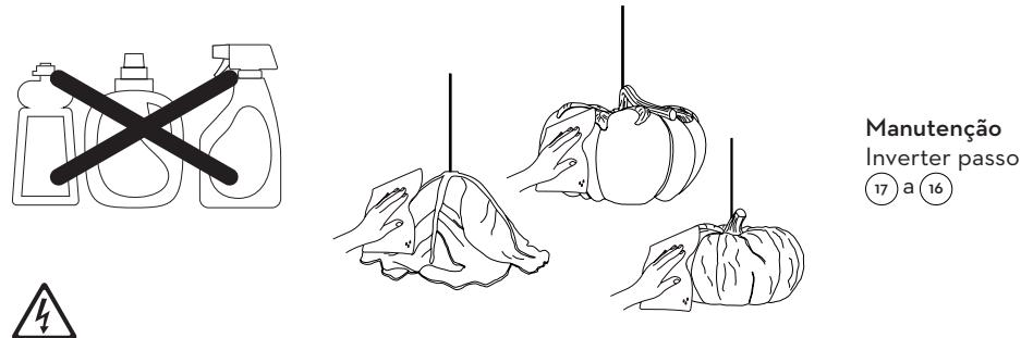
Para proceder à limpeza do cabo de alimentação deve usar um pano macio levemente humedecido com água, sem detergentes ou abrasivos. Se o cabo exterior flexível deste candeeiro se danificar, deverá ser substituído exclusivamente pelo fabricante, pelo seu representante ou por uma pessoa qualificada, para evitar acidentes.
